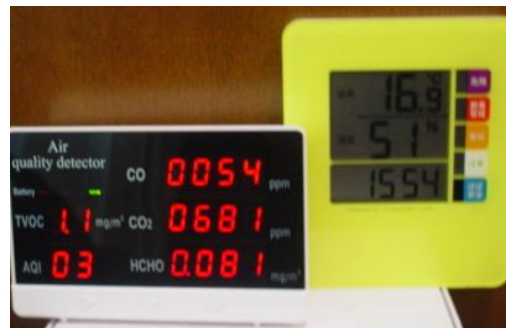
■CO2 濃度から「密」のリスクを察知(左)。湿度計でウイルス対策と喉の乾燥対策(右)。寒さには閉口したが、会堂全体の換気機能は万全だった。
